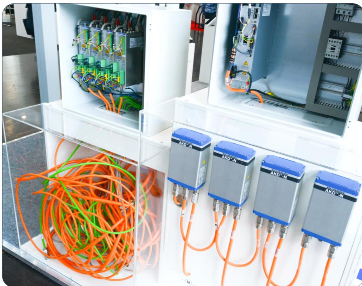
cavo motore, è possibile eliminare un'interfaccia. Il risparmio diventa tangibile grazie all'eliminazione di un cavo e di due connettori. Di conseguenza, si riducono i tempi di installazione e l'ingombro del cablaggio. I vantaggi, tuttavia, hanno il loro prezzo, che dipende dal cablaggio stesso. Per i produttori di cavi noti, i cavi del motore e del trasduttore sono compresi nella dotazione standard. Lo stesso vale per i connettori. Grandi quantità di
